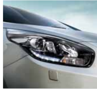
مصابيح أمامية LED تعمل عند إدارة المحرك Daytime Running Lights (D.R.L) w/ LED Lights
